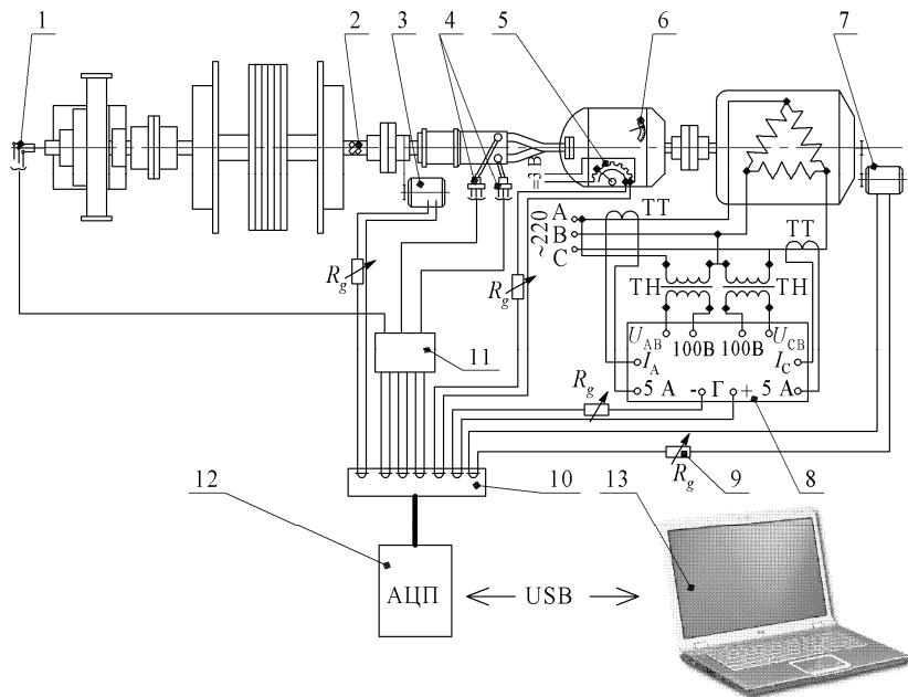
Рисунок 2 – Електросхема стендових експериментальних досліджень гідростатичного привода
